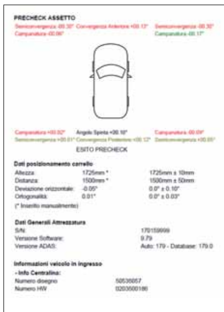
Esempio di Precheck Assetto Example of Precheck Asset
